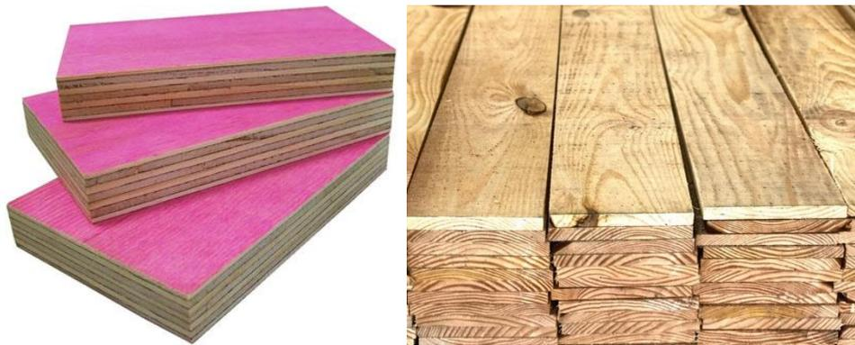
Figura 1 - Chapa em madeira compensada resinada (esq.) e chapa em pinus de 2ª categoria (dir.)
