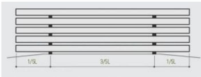
**Figura 2 - Método de armazenamento de estaca pré-fabricada**
